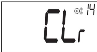
Halten Sie zum Zurücksetzen die Taste
