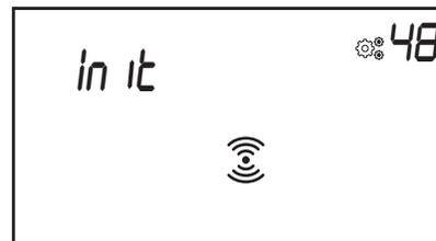
Wenn sich der Thermostat in der Funk-Kopplungsphase befindet, sendet er ohne Unterbrechung bidirektionale Kopplungsframes (Paarungssignale).
